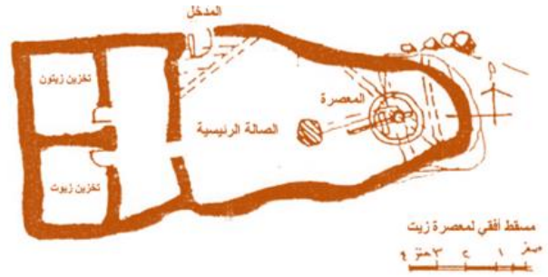
شكل رقم 9 : مسقط أفقي لأحد معاصر زيت الزيتون [6]
