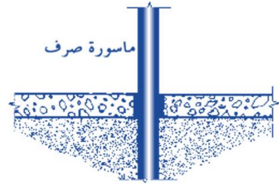
شكل رقم 12 العزل الجيد للمواسير و التمديدات حتي لا يستخدمها الشغالة للوصول إلي داخل المبني.
