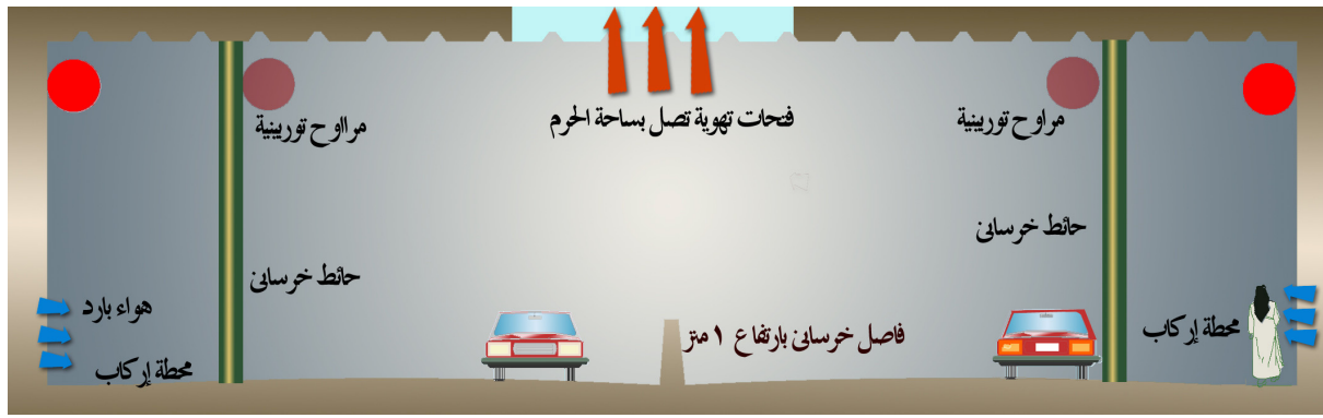
شكل رقم : 4 قطاع رأسي في النفق يوضح أجزائه الرأسية المختلفة.
